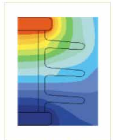
高電圧インシュレータの電位コンタープロット
